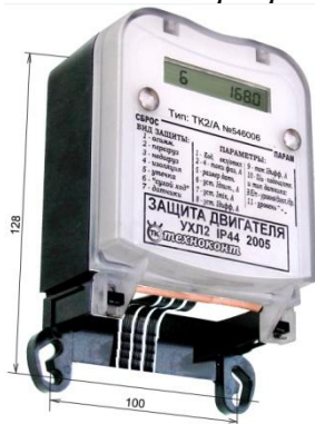
Габаритные размеры – не более 160*100*55. ТК крепится в трех точках, отверстия для крепления R2,5. Рис.2 Внешний вид, габаритные и установочные размеры
