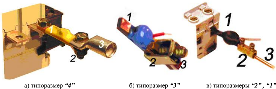
Рис. Внешний вид датчиков тока и примеры их подключений
